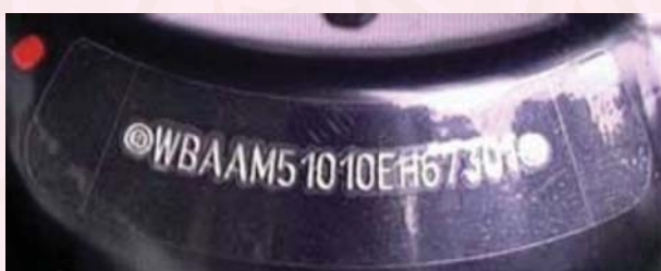
Рис. 4. Расположение и внешний вид идентификационного номера автомобиля
