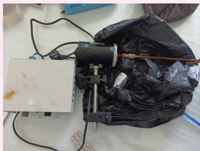
Рис. 8. Мешалка верхнеприводная со следами красновато-серого оттенка.
