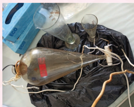
Рис. 6. Делительная воронка с массой красновато-серого оттенка и конические мерные стаканы с незначительными следами беловато-серого оттенка.
