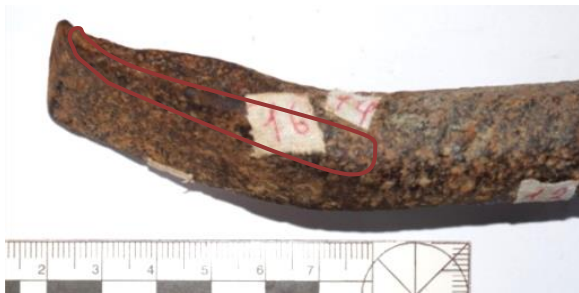
Рис.6 Отображение участка на боковой поверхности расплющенного конца монтировки, которым причинены экспериментальные следы.
