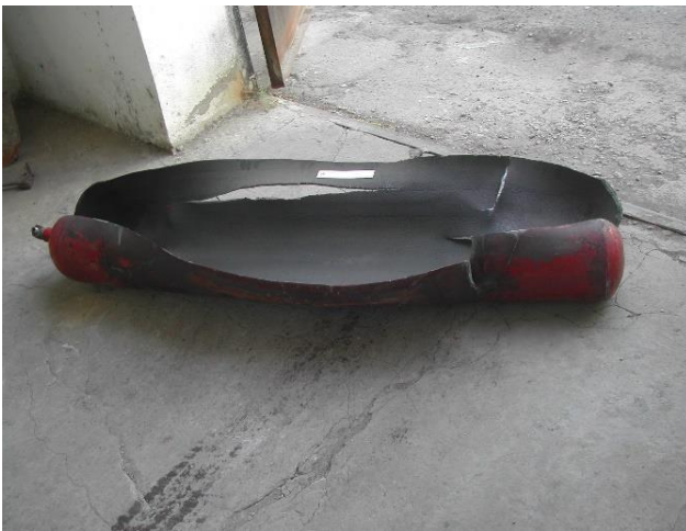
Rasm. Yoqilg'i gaz ballonlarning fizik portlashdan keyingi holati.
