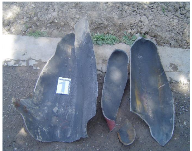
Rasm. Yoqilg'i gaz ballonlarning fizik portlashdan keyingi holati.
