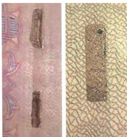
20. Rasm. Chizilgan va bosilgan folga bilan “Sho‘ng‘in” himoya ipining taqlid qilingan usuli.
