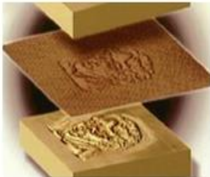
6. Rasm. Suv belgisi naqshining shtampini o'yib yozish va suv belgisi naqshini to'r ustiga chizish.
