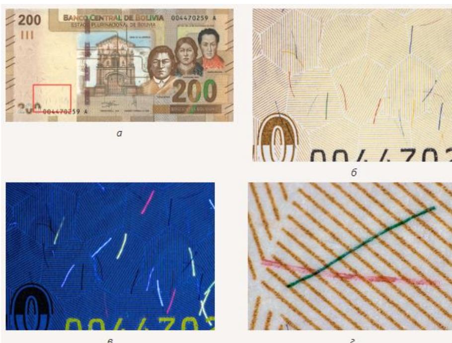
23. Rasm. a) banknotaning -old tomoni. Qog'oz substrakt; b)-himoya tolalari: ko'rinadigan va ko'rinmas bitta rangli. Yoruqlikdagi ko'rinishi; v) xuddi shu 365 nm ultrabinafsha nurlaridagi ko'rinishi.
