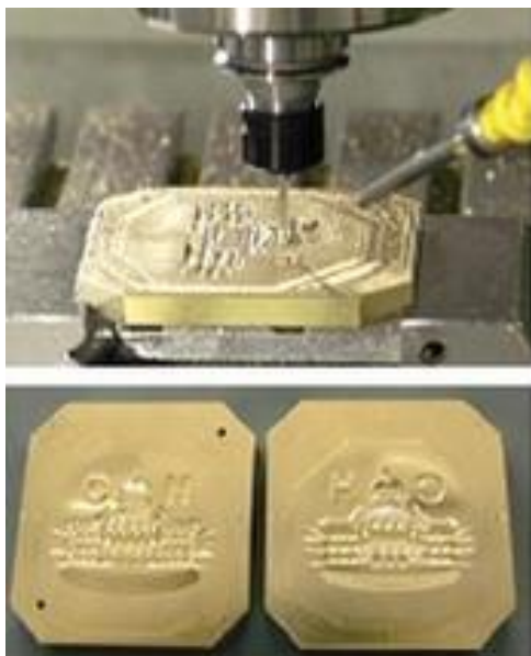
6. Rasm. Suv belgisi naqshining shtampini o'yib yozish va suv belgisi naqshini to'r ustiga chizish.
